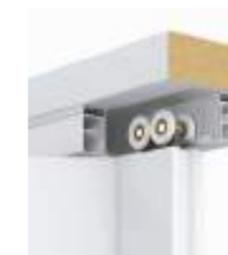
Carril de aluminio de gran consistencia. Carros de deslizamiento con rodamientos de bolas, jaula de acero templado y valona de rodadura de Poliamida
