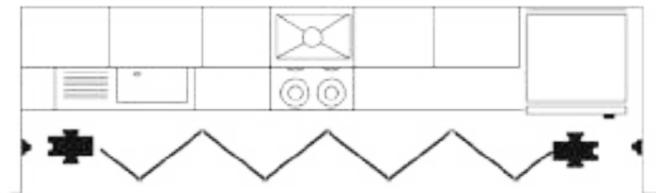
Puerta de una hoja con apertura por ambos lados. Facilita la accesibilidad y la limpieza de cocinas, armarios, despensas y otras aplicaciones.
