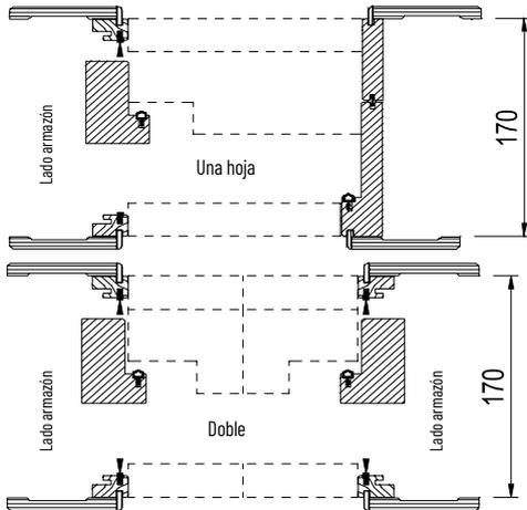
Jamba de abeto juntado ennoblecido con aglomerado de virutas de fresno natural en el acabado de fresno lacado, con guarniciones y cepillo. La jamba siempre deberá adaptarse a la luz de paso durante la instalación, mediante simples cortes. Perfiles tapajuntas disponibles bajo pedido con aleta de 5 o 15 mm.
