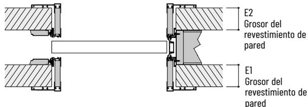
Según la variación del grosor de la pared, las prolongaciones se suministrarán en una sola pieza o en dos, como se muestra en el diagrama.
