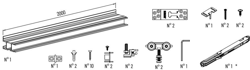
Kit de cierre vertical y recubrimiento de madera
