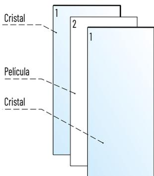
Cristal estratificado formado por dos paneles de cristal (1) en medio de las cuales se coloca una película de material plástico PVB (2) transparente que se adhiere perfectamente a las dos superficies de cristal, creando así un panel único.
