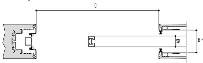
La luz de paso real una vez instalada la puerta se ve reducida 10 mm en anchura en el caso de una hoja.
